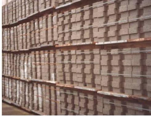
*Figura 2. Disminución de eflorescencias en bloques de hormigón sin hidrofugar frente a bloques de hormigón que incorporan un aditivo hidrófugo de Sika*
