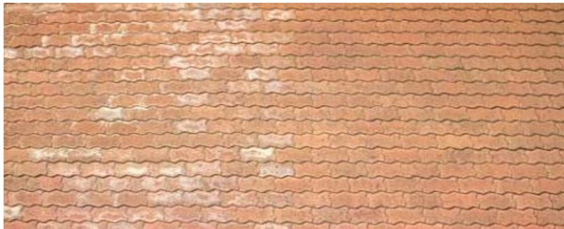
*Figura 3. Disminución de eflorescencias en bloques de hormigón coloreado, a la izquierda sin hidrofugar, a la derecha incorporando un aditivo hidrófugo de Sika*
